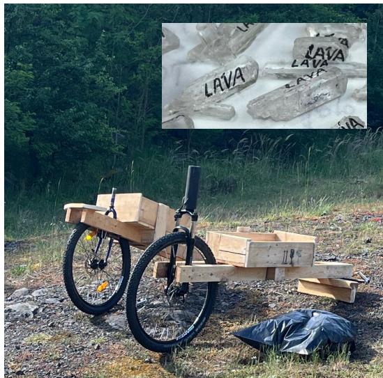
Kolečka před použitím a po nasazení kol - vzor 29" v popředí, vzadu 26"
